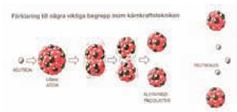
Figur 4.2 Schematisk beskrivning av klyvningsprocessen (fission). En neutron infångas av en uranatom, som exciteras och klyvs (fissionerar) i två delar (klyvningsprodukter). Samtidigt avges ett antal neutroner.
