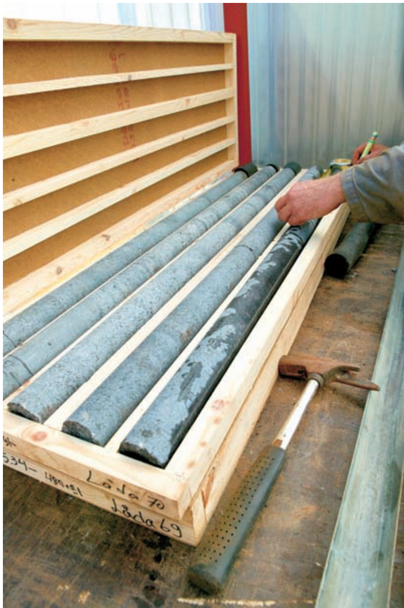
Mätning av borrkärnor från provborrningar. Foto Carl-Robert Lindqvist. Källa: SKB.
